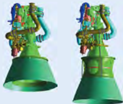
▲ Двигатель НК-33-1. Выдвижной насадок увеличит удельный импульс ЖРД
