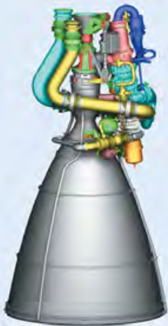
▲ Двигатель НК-43М. Для системы «Воздушный старт» его необходимо будет дооснастить новыми и модернизированными блоками и агрегатами (выделены цветом)
