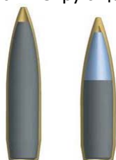
Разрез пуль патронов Mk.262 (слева) и M855 (справа)
