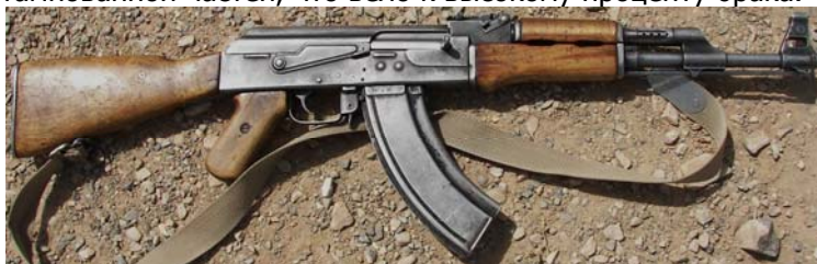
Автомат Калашникова образца 1947 года с штампо-клепаной ствольной коробкой
