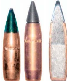
Пуля патрона M855(слева) и M855A1 (справа — общий вид и разрез)
