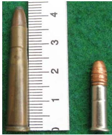
Патрон калибра .22 Hornet (слева) в сравнении с патроном .22 Long Rifle (справа)
