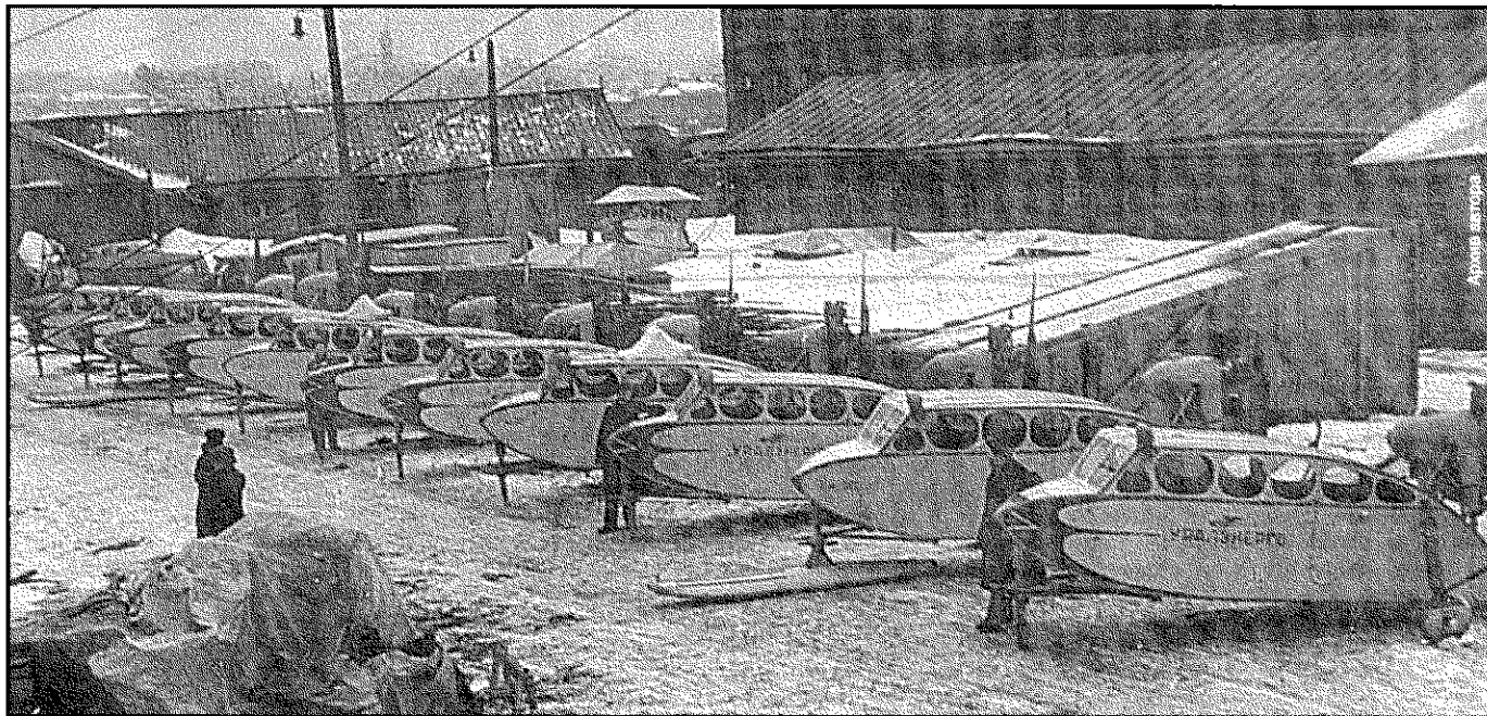
Группа аэросаней ОСГА-6 во дворе отдела строительства глиссеров и аэросаней СНИИ ГВФ. На военных санях видны зачехленные пулеметные турели
