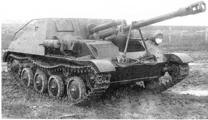
Самоходная установка ОСУ-76 Боевая масса – 4,2 т; экипаж – 3 чел; оружие: пушка – 76,2 мм; броня – противопульная; мощность двигателя – 50 л.с. (37 кВт); максимальная скорость – 41 км/ч
