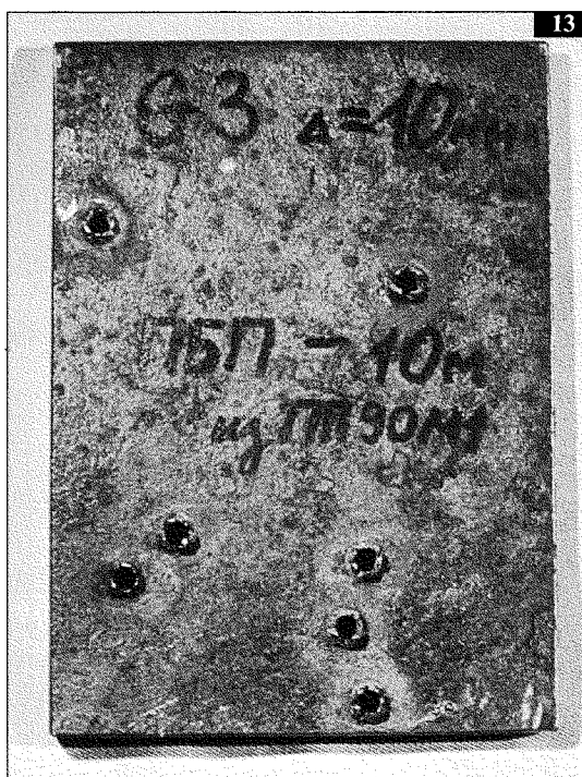
13. 10-мм стальная пластина, пробитая пулями патрона 7Н31
